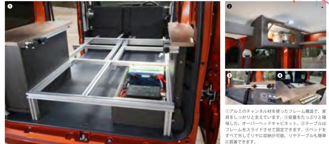
①アルミのチャンネル材を使ったフレーム構造で、家具をしっかり支えています。②容量をたっぷり確保した、オーバーヘッドキャビネット。③テーブルはフレームをスライドさせて固定できます。④ベッドをすべて外してリヤに収納が可能。リヤテーブルも簡単に脱着できます。
